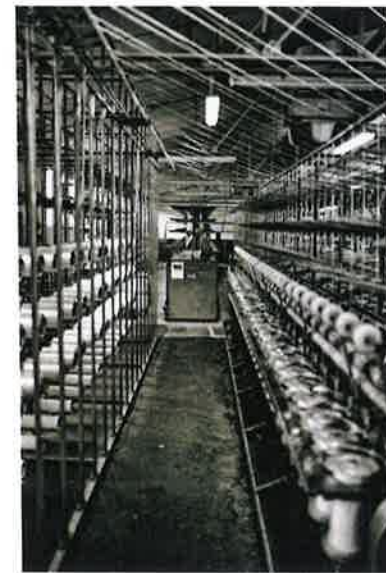
Préparation et retordage des fils, chargement d'une tresseuse et épissage d'une tresse. Preparation and twisting of threads, loading a braiding machine, and splicing a braid.
